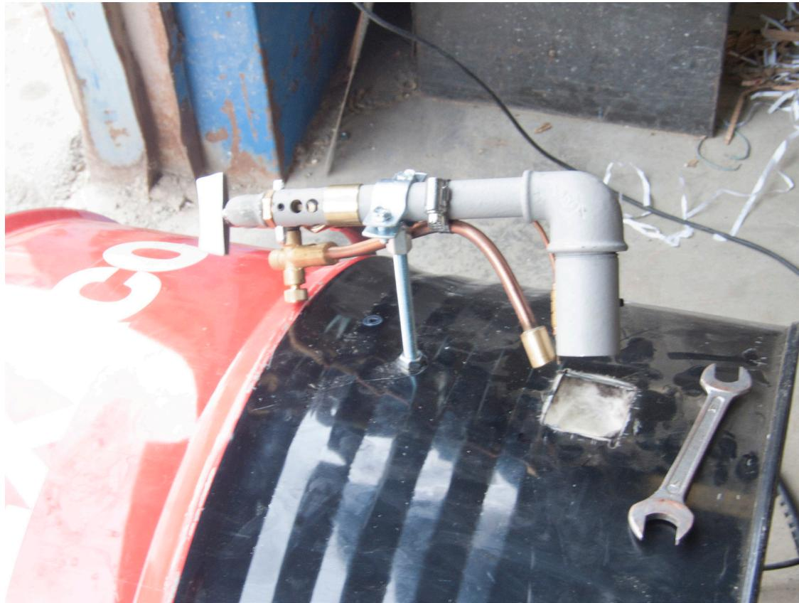
Ya terminada la parte de montaje de horno, haremos una perforación con broca del 3 a mitad del bidón para colocar la caña pirométrica, la cual hace el importantísimo trabajo de mostrar la temperatura interior del horno.
