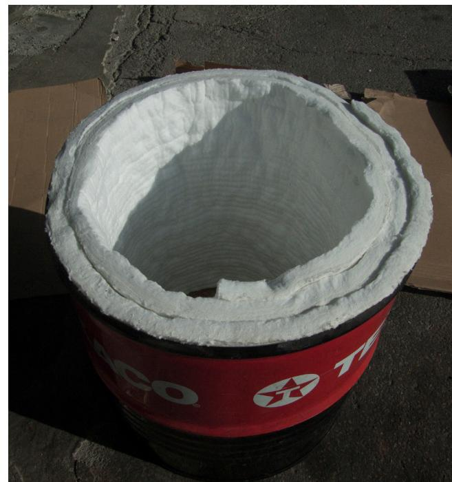
La colocación de la manta refractaria es tan simple como darle dos vueltas justas de manta al perímetro del bidón. Se mide el perímetro del bidón internamente y se multiplica por dos. Cortamos la manta a la medida que nos haya resultado y acto seguido la colocamos.
