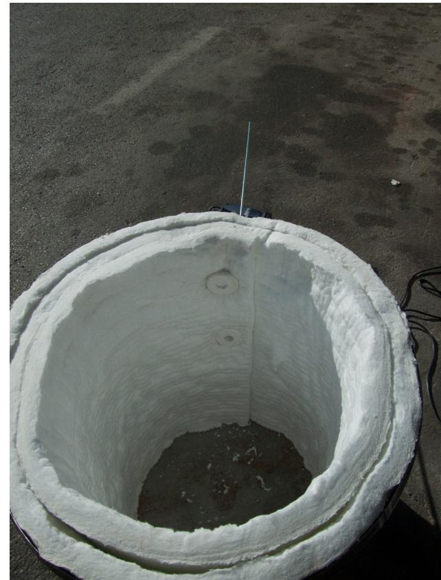
La tapadera contiene 4 cuplos, dispuestos en forma cuadrada y cuidando de no ponerlos muy al centro, ya que en esa zona hay que hacer una perforación de 8 por 8 centímetros para que el horno respire. Estos cuplos, de fabrica traen una pequeña perforación, insuficiente para la varilla de 8 mm, con lo cual hay que taladrarlo con broca de piedra del 8. La ventana en la chapa se corta con la amoladora, mas conocida como “marranillo”
