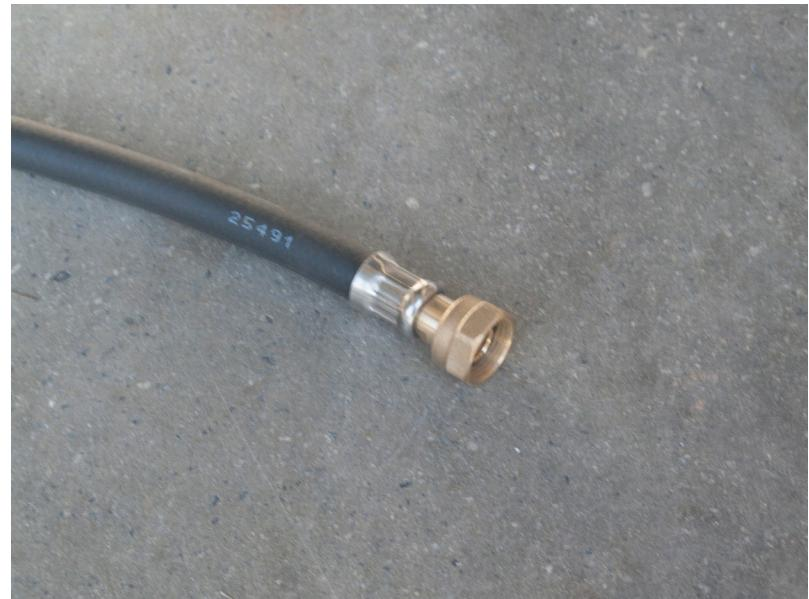
En la imagen apreciamos como esta lira blindada es de buena calidad, con las dos bocas de conexión blindadas con cobre.
